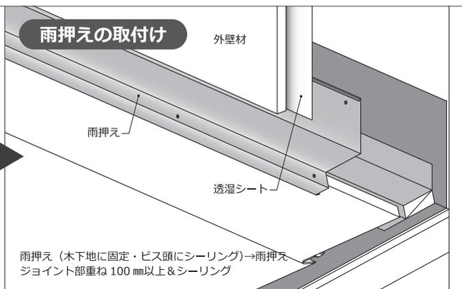
雨押え (木下地に固定・ビス頭にシーリング)→雨押えジョイント部重ね 100 mm 以上&シーリング
