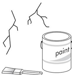
屋根表面の塗膜のキズは清掃後に布などで油・ゴミを完全に除去し、それぞれ表面材と同色の専用補修塗料で塗装補修してください。
